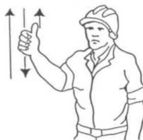
4 Levantar el aguilón o pluma lentamente
