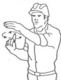
3 Levantar la carga lentamente
