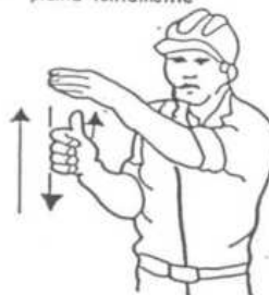
4 Levantar el aguilón o pluma lentamente
